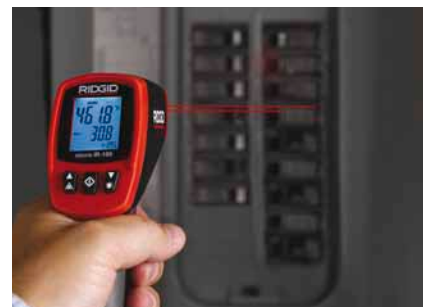
Проверка предохранителя или автоматического прерывателя на предмет перегрева, который могут вызвать перегруженные электрические цепи
